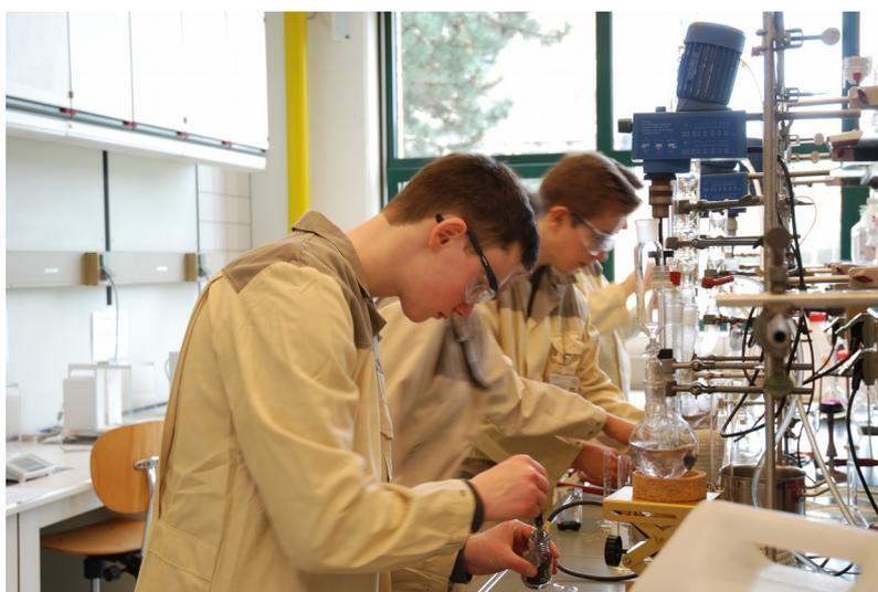
Anschließend wurde der Ausgangsstoff der Paracetamolsynthese, 4-Aminophenol, über einen Pulvertrichter in die Apparatur gegeben. Durch das Hinzugeben von Essigsäureanhydrid sowie durch das Erwärmen des Gemisches mit einem Heizpils wurde eine wässrige Suspension von
